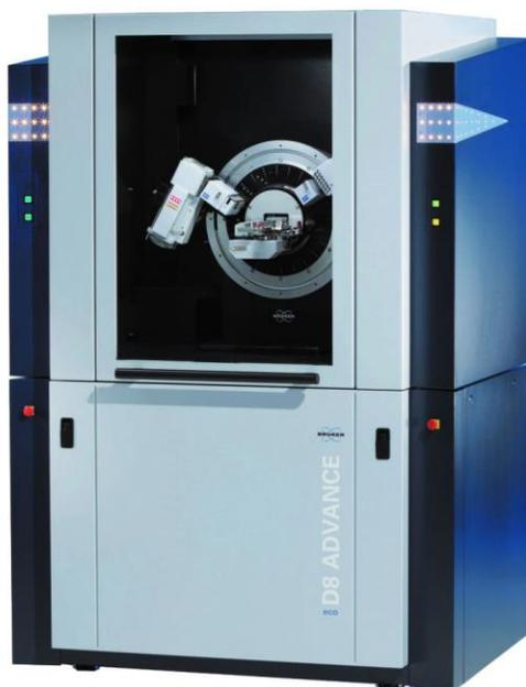
Рисунок 8-D8 DISCOVER Bruker: Универсальный дифрактометр
