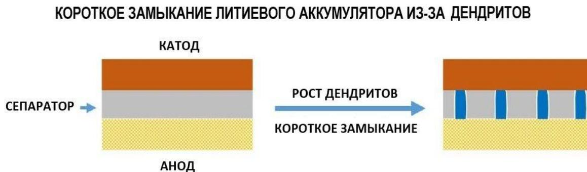
Рисунок 2- короткое замыкание
